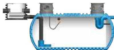
▲ Filtre dégrilleur VF6 dans regard PE mis en œuvre avec stockage DP 11 000 l.
