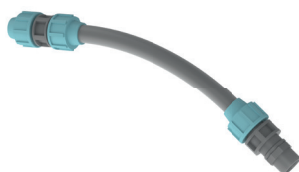
Kit de sortie de poste souple : KSS 50 1 raccord PVC et 1 tuyauterie souple (lg 600 mm) + 2 raccords à compression. Adaptable sur une canalisation PVC ou PEHD Ø50.
