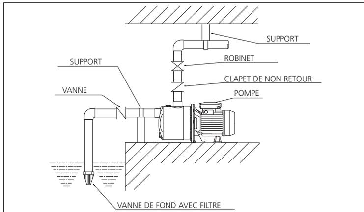
Pour une installation correcte du système, nous conseillons de prévoir une vanne de fond en aspiration et un support/ancrage pour les tuyauteries.
